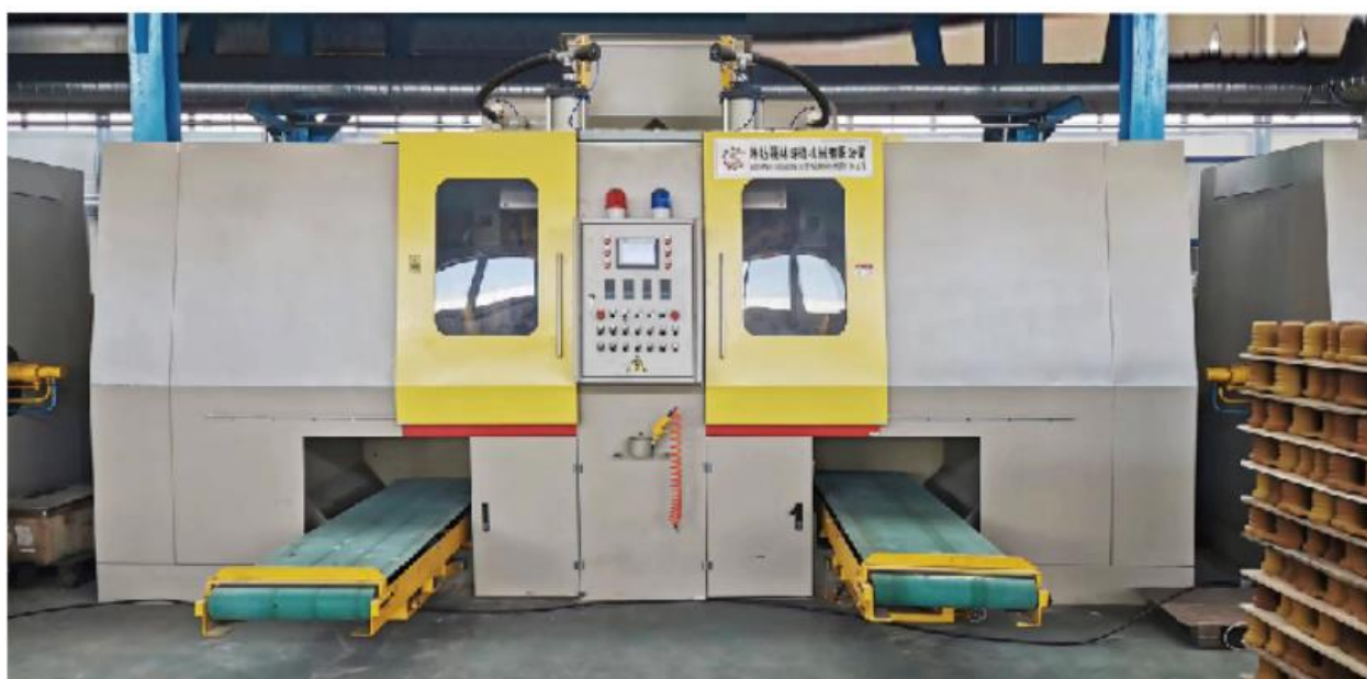
Z957SG-40D Автоматическая двух-станционная стержневая машина для изготовления стержней из плакированных песков по Кронинг процессу
