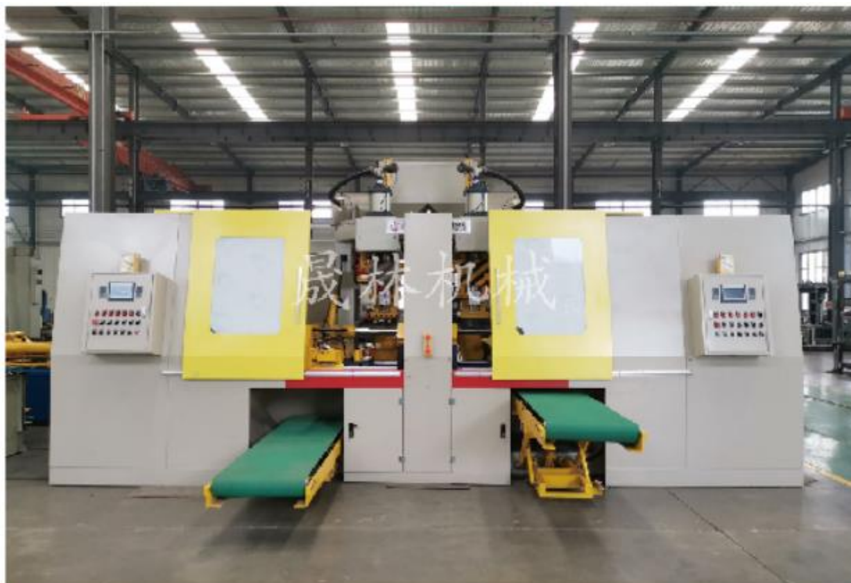
Z9408SG-60D Автоматическая двухстанционная стержневая машина с нагреваемой оснасткой (Hot Box)
