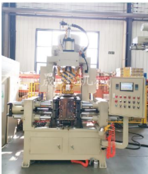
Z9406R-20B Автоматическая стержневая машина с одним нагреваемым стержневым ящиком
