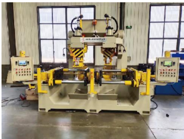
Z956SG-30B Автоматическая двух-станционная стержневая машина для стержней по Кронинг-процессу
