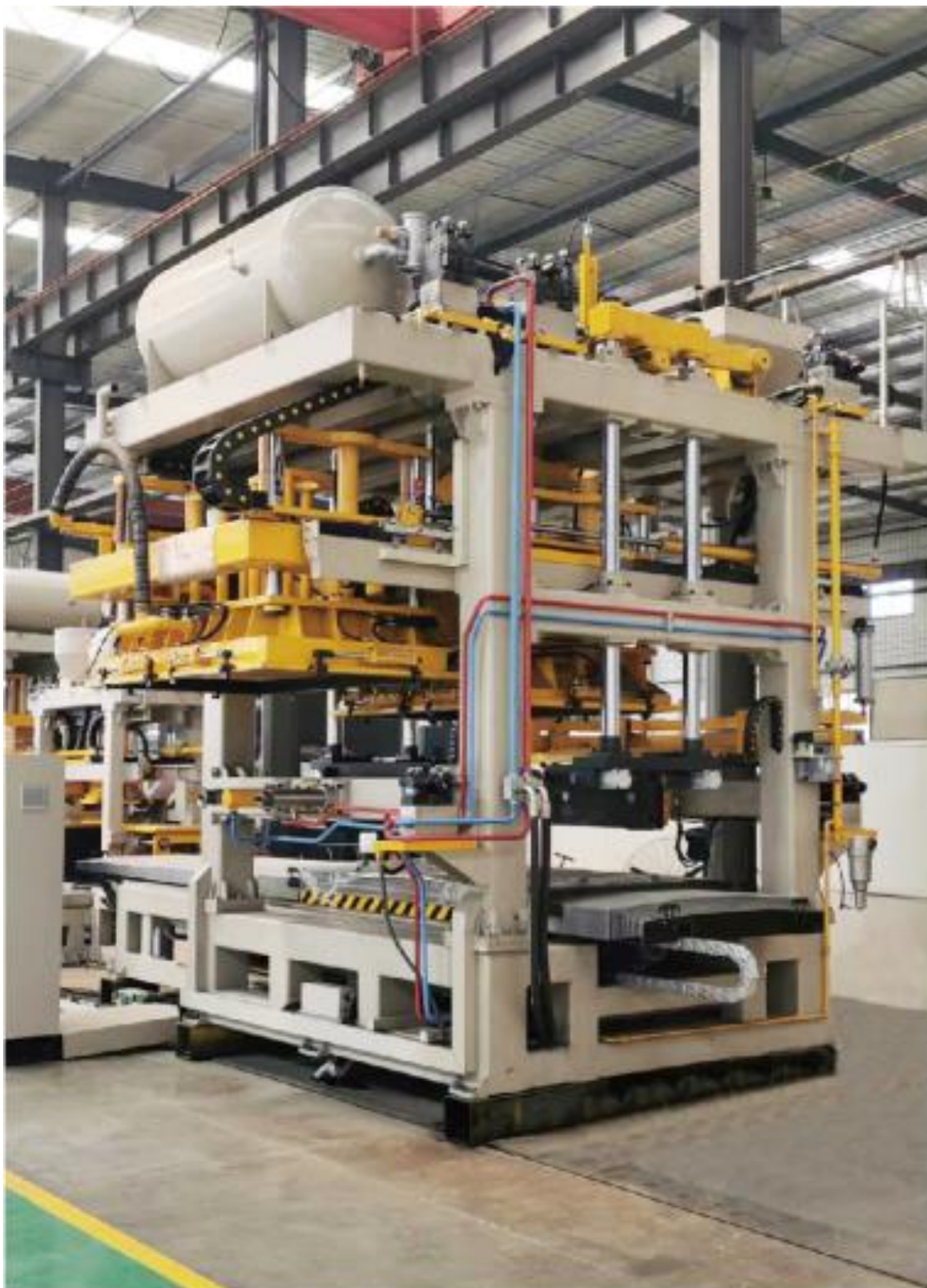
Стержневой автомат 200 л - для изготовления больших стержней
